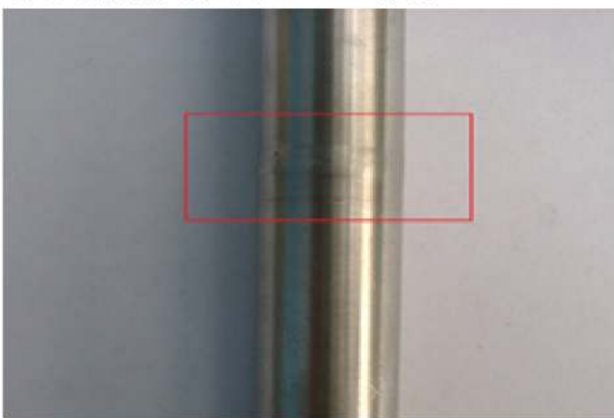
图 5.2.8-1 外焊缝成型质量
