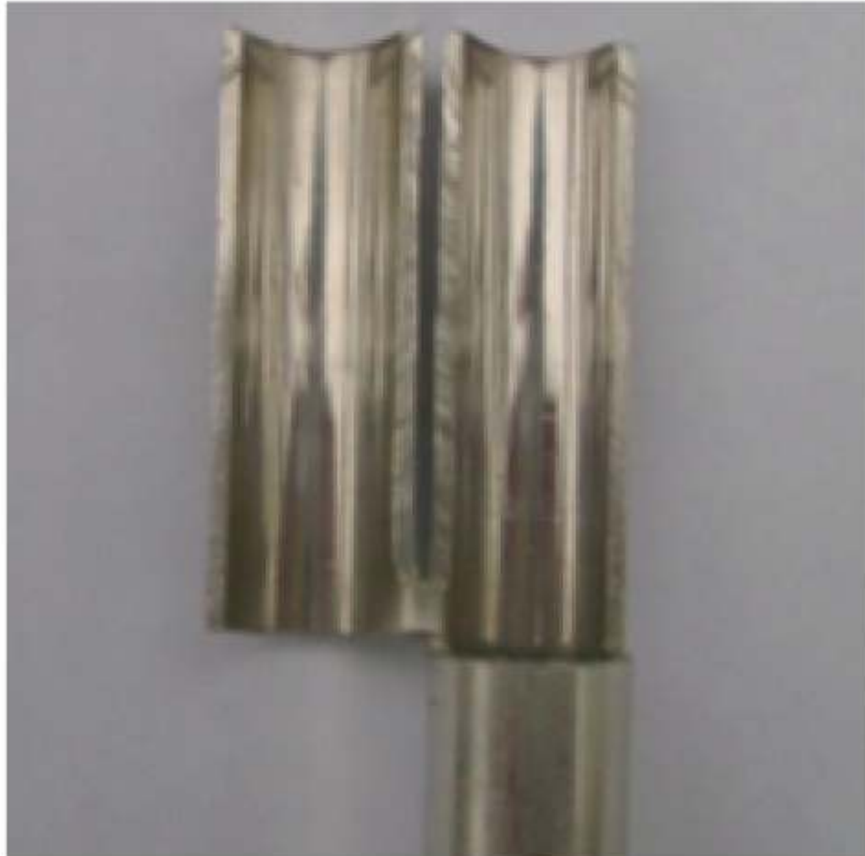
图 5.2.8-2 焊缝内侧成型质量
